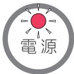
微酸性電解水の残量不足や異常が発生すると電源ランプが赤色に点滅します。（※）
