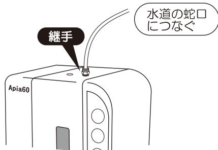
③ 微酸性電解水出口(OUT)側に付属の継手を接続して、適合する耐圧チューブ取付ける。
