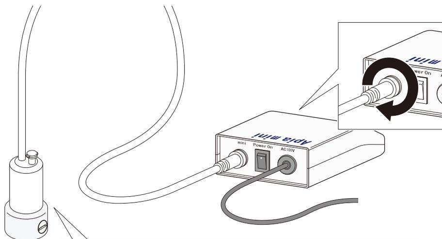
本体（白筒部）と底キャップのねじの緩みがないことを確認してください。接続部の緩みにより正しい性状の微酸性電解水ができないことがあります。
